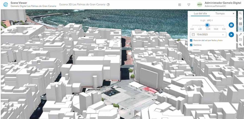
Fotografía 9: Fotograma del video generado por el Gemelo digital con los datos meteorológicos y de proyección de sombras del año 2023 sobre la Plaza del Pilar de LPGC (vista hacia la Playa de Las Canteras).
